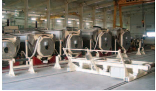
Beim **AMIJACK**-Fertigungsprozess werden die Rohstoffe in definierten Mengen in die Schleuderformen eingebracht, damit sich eine kompakte, schichtförmige Rohrstruktur bildet. Die Grundstoffe werden über einen speziellen Feeder präzise dosiert und gemäß der Spezifikation für das zu fertigende Rohr zugegeben. Die Rohre werden aus den folgenden Rohstoffen gefertigt:
