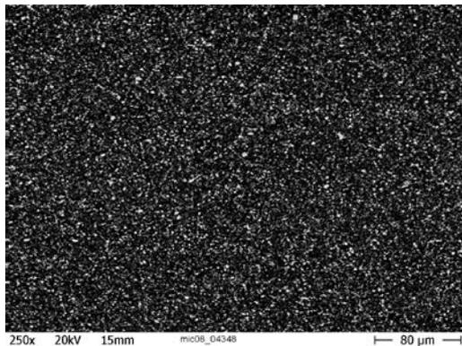
**Bild: Probe von KG 2000 Rohr, REM-Aufnahme mit 250facher Vergrößerung mittels COMPO-Mode**
