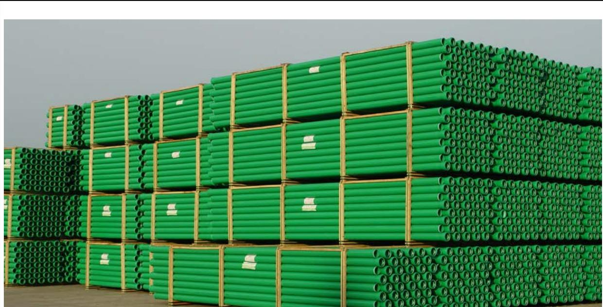
**Bild 1: Abwasserrohre aus PP-MD**
