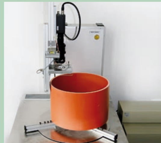
Nachweis der gleichmäßigen Schaumstruktur sowie der Wandungsmaße Prüfung der Gleichmäßigkeit der Schaumstruktur sowie der Maße des Wandaufbaus durch ein Bildanalyse-System
