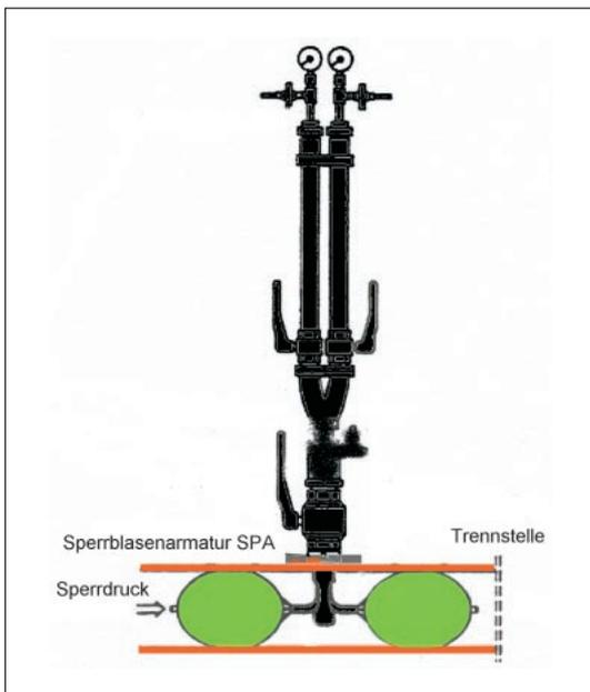
**Bild 6:** Schemadarstellung einer Absperrung mit Sperrblasen
