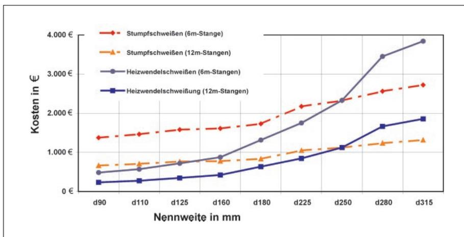
**Bild 2:** Heizwendelschweißfittings als T-Stück oder Winkel bis *d* 225 bieten Potential zur Kostenreduzierung
