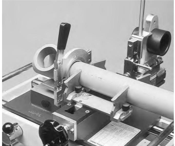
Nach dem Anwärmen ziehen Sie Rohr und Formteil langsam von den Heizwerkzeugen ab, schwenken das Heizelement aus und fügen Rohr und Formteil sofort zusammen. Achten Sie auf die Halte- und Abkühlzeit.
