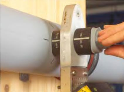
Schieben Sie den Aufschweiss-Sattel und das Rohr gleichzeitig auf die Heizbuchsen. Anwärmzeiten siehe Tabelle 1.
