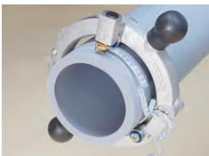
Hobeln Sie die oberste Schicht in einem Durchgang mit Schälwerkzeug ab.
