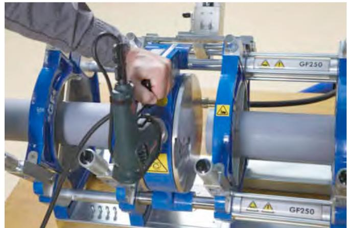
Legen Sie den Hobel in die Schweissvorrichtung ein und schalten Sie den Antrieb des Hobels ein.
