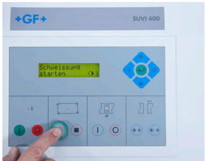
Auf dem Display erscheint: Schweissung starten. Drücken Sie die grüne Taste >bis die rote Kontrolllampe in diesem Feld leuchtet. Die beiden Rohre oder das Rohr und das Fitting fahren zusammen.
