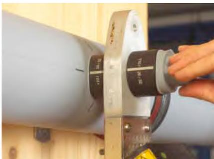
Schieben Sie den Aufschweiss-Sattel und das Rohr gleichzeitig auf die Heizbuchsen. Anwärmezeit siehe Tabelle 2.
