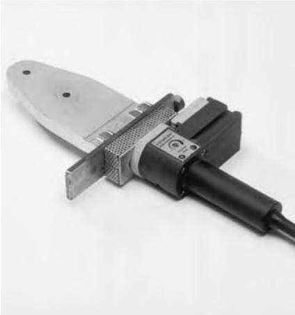
Das Handscheissgerät wird elektrisch beheizt (230 V/50 Hz), mit einer Leistung von 800 W. Der Scheisspiegel ist auch in einer 110 V/60 Hz Version für England erhältlich. Die elektronische Temperaturregelung sorgt für gleichbleibende Temperatur an den Heizwerkzeugen.
