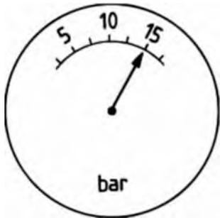
Um eine einwandfreie Prüfung durchzuführen, füllen Sie die Installation langsam und entlüften sie wieder vollständig. Setzen Sie für die Prüfung geeichte Messgeräte ein, auf denen Druckänderungen von 0,1 bar ablesbar sind.
