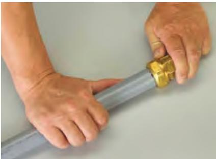
Schieben Sie das Rohr bis zum Muffen-
