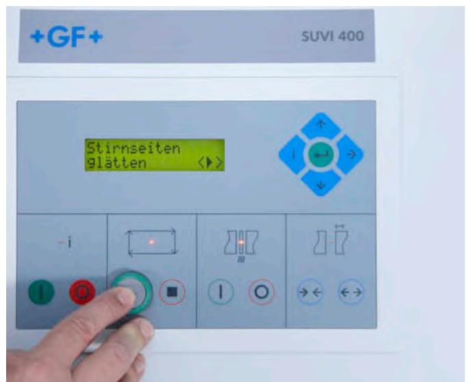
Auf dem Display erscheint: Stirnseiten glätten. Drücken Sie die grüne Taste > bis die rote Kontrollleuchte in diesem Feld leuchtet. Wenn auf beiden Rohrenden ein Hobelspan ohne Unterbrechungen abgehobelt wurde, bestätigen Sie mit der grünen Taste > bis die rote Kontrollleuchte in diesem Feld leuchtet.
