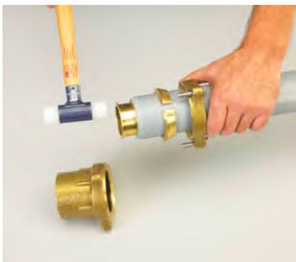
Schieben Sie den Flansch und den Klemmring über das Rohr. Schlagen Sie den Stützring komplett in das Rohr ein.
