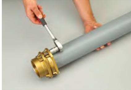
Achten Sie darauf, die Schrauben gleichmäßig anzuziehen, so dass sich die Teile nicht verkanten können. Ziehen Sie die drei Schrauben an, um den Flansch formschlüssig mit dem Verschraubungskörper zu verbinden.
