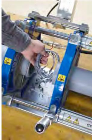
Reinigen Sie die Verbindungsflächen der zu verschweißenden Teile - Fitting und Rohrende. Benutzen Sie zum Reinigen ein saugfähiges, nichtfaserndes Papier und Reinigungsmittel **Tangit KS-Reiniger, Art.-Nr. 799 298 023**. Entfernen Sie die Reinigungsflüssigkeit restlos mit dem Reinigungspapier.
