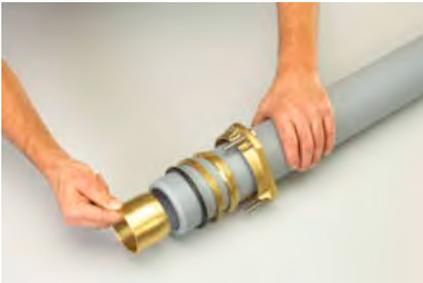
Schieben Sie den Flansch, den Klemmring, den Stützring und den O-Ring in dieser Reihenfolge auf das Rohr.
