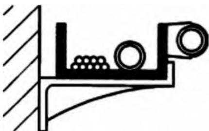
Je nach Rohrdimension können die Leitungen mit **Rohrklips** oder **Kabelbindern** befestigt werden.
