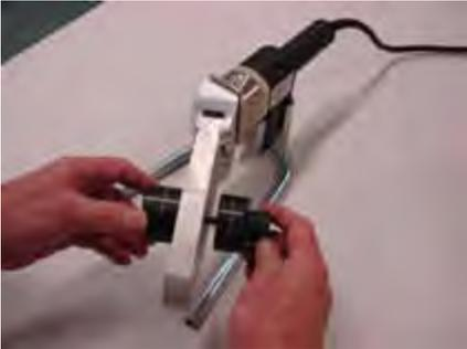
Montieren Sie die Heizbuchsen auf den Schweiss-Spiegel.
