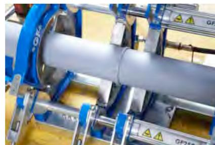
Entnehmen Sie die verschweissten Rohre oder Rohr und Fitting. Resultat: Sie haben eine Stumpfschweissverbindung geschweisst.
