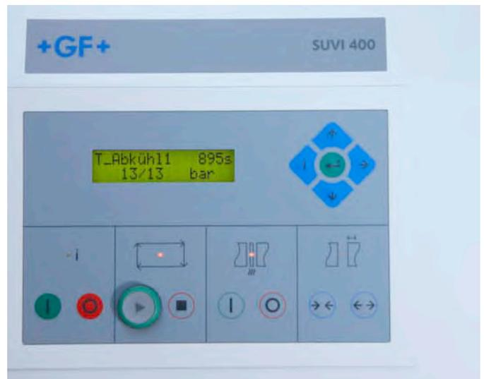
Auf dem Display wird angezeigt, wenn die Abkühlzeit beendet ist. Drücken Sie die grüne Taste Enter. Das Schweissgerät entlastet die Schweissung.
