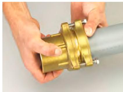
Achten Sie darauf, die Schrauben gleichmässig anzuziehen, so dass sich die Teile nicht verkanten können. Ziehen Sie die drei Schrauben an, um den Flansch form-schlüssig mit dem Verschraubungskörper zu verbinden.
