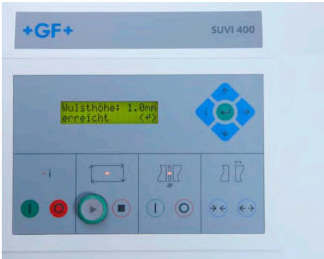
Auf dem Display erscheint: Wulsthöhe: 1.0mm erreicht. Diese Angabe muss durch den Schweißer optisch kontrolliert werden. Bestätigen Sie mit der grünen Taste Enter. Das Schweissgerät senkt den Anpressdruck auf den Schweissspiegel.
