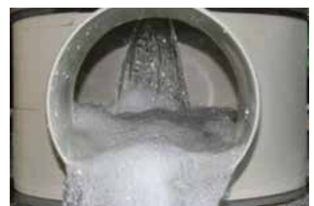
Abfluss aus der Wechselblende
