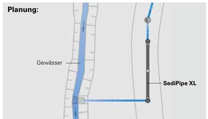
vorhandener Regenwasserkanal mit SediPipe-Vorreinigung
