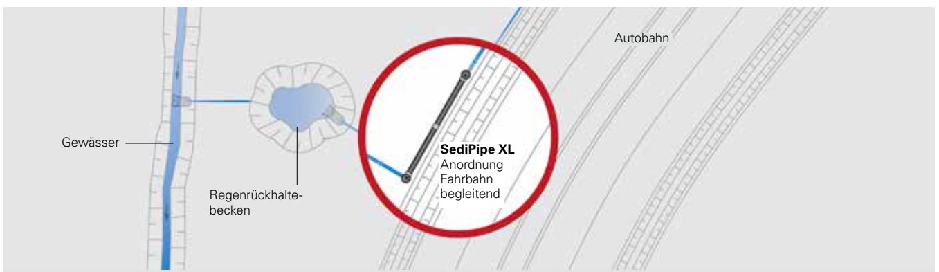
Straßenbegleitende, dezentrale Anordnung einer SediPipe mit platzsparender Anordnung direkt im Seitenbereich der Straße
