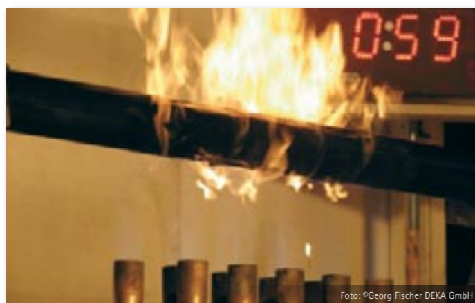
Brandtest an einem Kunststoffrohr nach IMO 753 Standard
