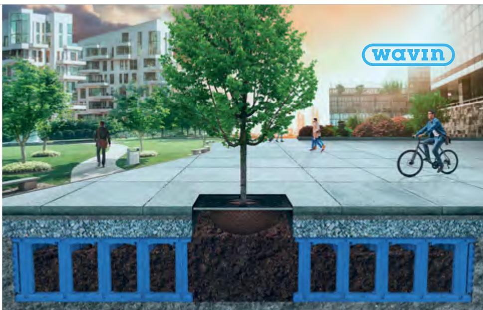
Bild 5: Versiegelte Flächen und verdichtete Böden verringern die Wasser- und Nährstoffzufuhr des Stadtbaums. Der Wavin TreeTank trägt dazu bei, dass die Wurzeln von der Oberfläche in die Tiefe gelenkt werden. Dort finden sie gleichermaßen genügend Wasser wie Nährstoffe und verankern sich fest gegen Windlast.
