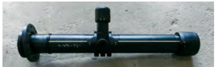
Bild 3: Prüfmuster Druckanbohrarmatur (DAA) für H<sub>2</sub>-Dichtheitsprüfungen
