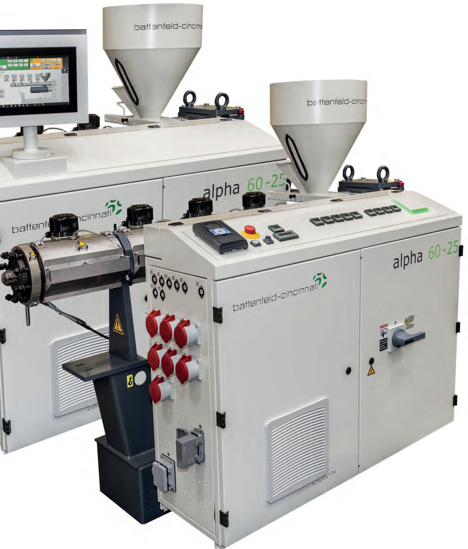
Bild 1: Extruder alpha plus mit einem Durchmesser von 60 mm von battenfeld-cincinnati
