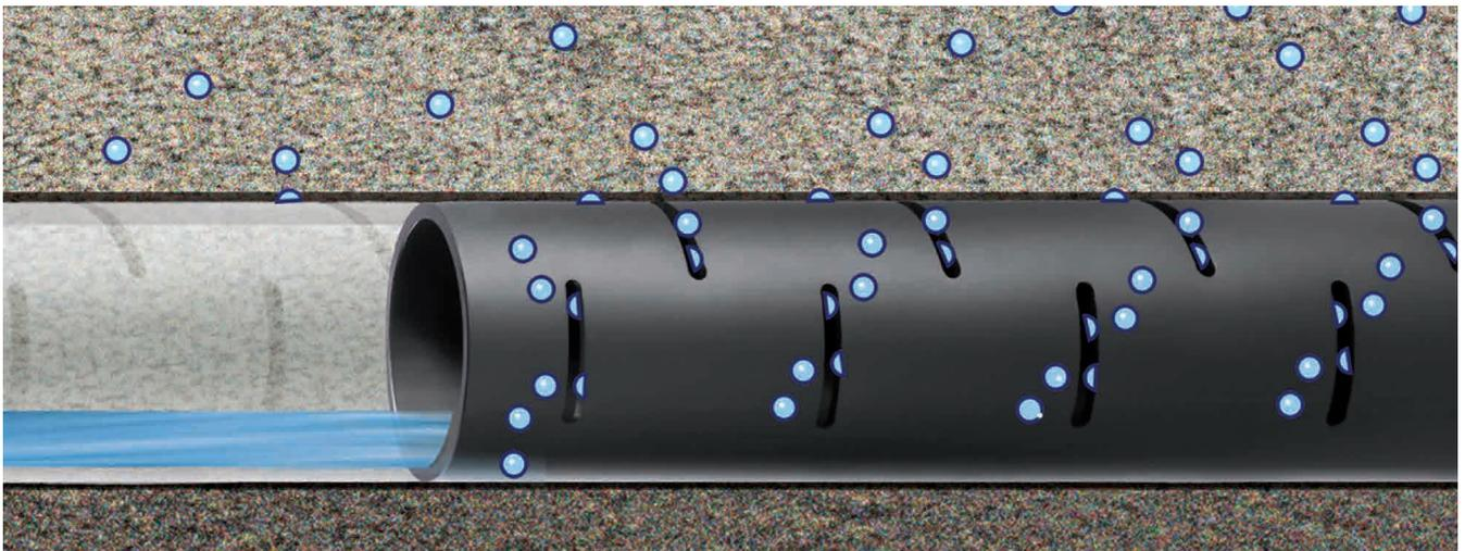
Prinzip der Aufnahme und Ableitung von Sickerwasser im Erdbauwerk
