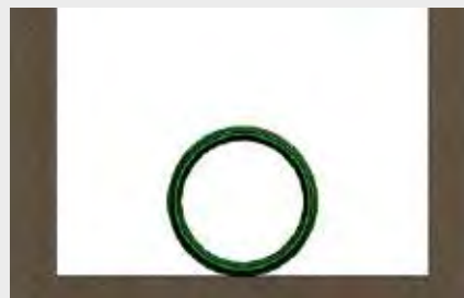
Typ 3: Auflager auf einer vorbereiteten Grabensohle
