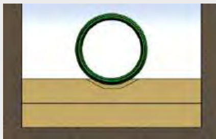
Typ 1: Auflager auf einer eingebrachten Bettungsschicht
