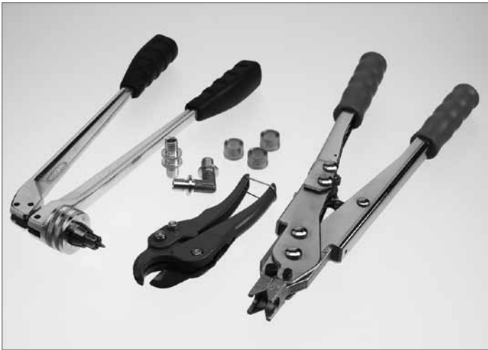
TECEflex Handwerkzeuge: Aufweitzange mit Aufweitkopf, Rohrschneidezange, Handpresszange mit Gabelköpfen (von links)
