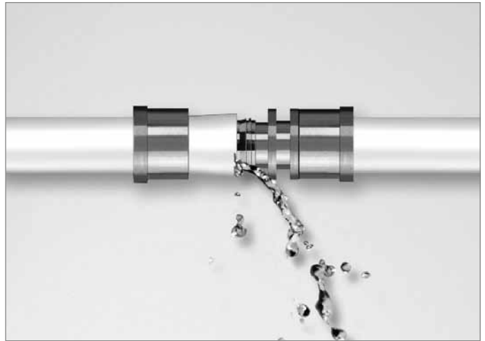
Zwangsendichtigkeit bei unverpressten Rohren
