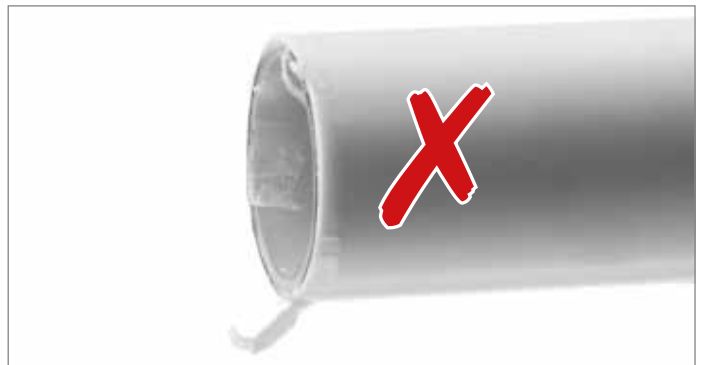
Falsch kalibriertes Rohr
