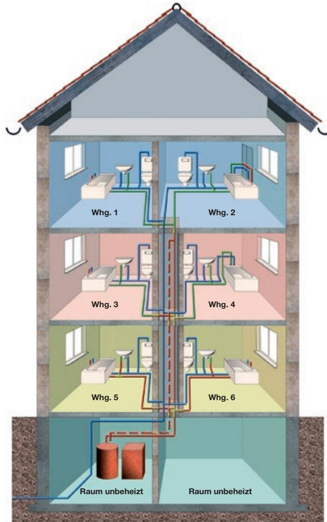
**Beispiele für Dämmstärken nach EnEV bzw. DIN 1988 bei typischen Installationen**
