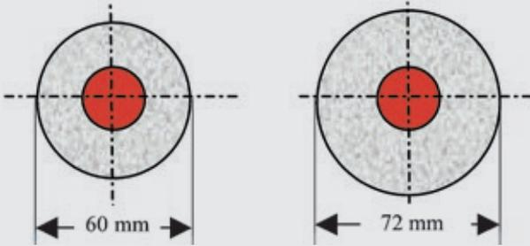
Abb. 23: Dämmschichtdickenvergleich am Beispiel Wavin Mehrschicht-Verbundrohr  $d = 20 \times 2,25 \text{ mm}$  (siehe auch Tabelle 4 und 5, Seite 83).
