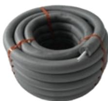
3. Wavin Mehrschicht-Verbundrohr ist im Ringbund mit **26-mm**-Dämmung (Wärmeleitfähigkeit = 0,040 W/m·K) lieferbar. Dieses System entspricht der erforderlichen Dämmstoffstärke für Leitungen bis 22 mm (gemäß Tabelle 1, Zeile 1 EnEV).
