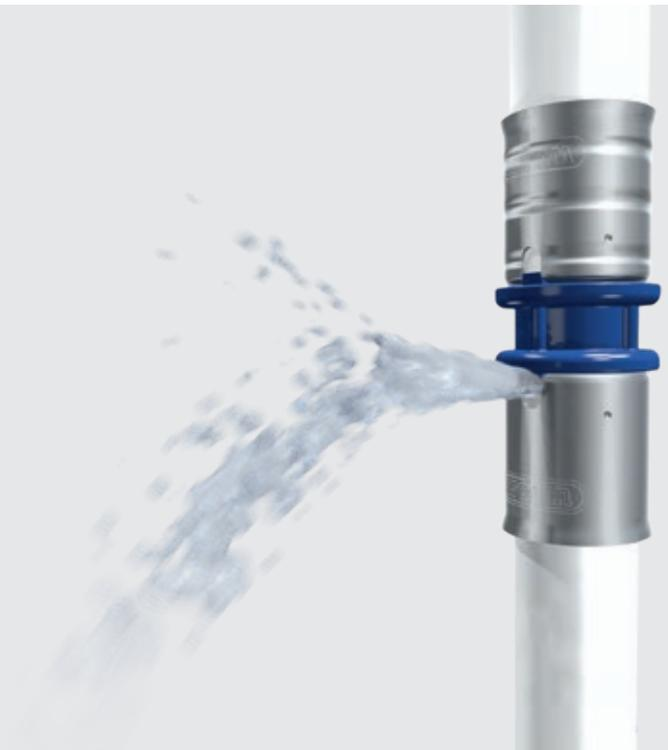
Abb. 5: Sicherheit durch clevere Technik: Die Leckagefunktion bei der Druckprüfung macht unverpresste Fittingverbindungen sichtbar.
