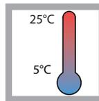
Die Verarbeitungstemperatur für Wavin Installationsrohrsysteme sollte  $-10\text{ °C}$  nicht unterschreiten. Der optimale Verarbeitungsbereich für Wavin Tigris K1/M1 und Wavin smartFIX Systemkomponenten liegt etwa zwischen  $5\text{ °C}$  und  $25\text{ °C}$ .
