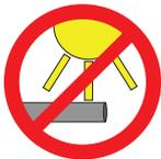
Wavin Mehrschicht-Verbundrohre sind vor direkter, intensiver Sonneneinstrahlung und Ultraviolett-(UV)-Strahlung zu schützen. Das betrifft sowohl die Lagerung der Rohre als auch fertiggestellte Anlagenteile.
