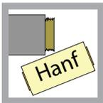
Die Herstellung einer Gewindeverbindung hat gemäß DIN 30660 zu erfolgen. Wir empfehlen die Verwendung von Hanf in Verbindung mit einem zugelassenen Fermit. Es sollte nur so viel Hanf aufgetragen werden, dass die Gewindespitzen noch zu sehen sind.
