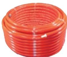
1. Wavin Mehrschicht-Verbundrohr ist im Ringbund mit **9-mm**-Dämmung (Wärmeleitfähigkeit = 0,040 W/m·K) lieferbar. Dieses System entspricht der geforderten Dämmung für Rohrleitungen im Fußboden (gemäß Tabelle 1, Zeile 7 EnEV).
