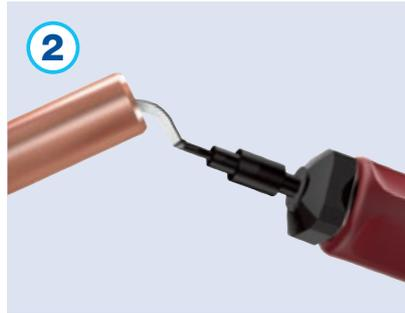
2 Kupferrohr innen und außen sorgfältig entgraten. Weiches Kupferrohr ist zu kalibrieren.
