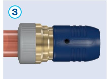
3 Übergangskupplung auf Sauberkeit und korrekten Sitz der Dichtelemente überprüfen. Übergangskupplung auf das Kupferrohr schieben. Dabei kein Öl- oder Gleitmittel verwenden.
