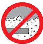
Der unmittelbare Kontakt von Wavin Installationsrohrsystemen mit Lösungsmitteln bzw. lösungsmittelhaltigen Baustoffen (wie Lacke, Sprays, Montageschäume, Kleber [z. B. Armaflex-Kleber 520] etc.) ist zu vermeiden.
