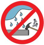
Die Wavin Systemkomponenten sind in der Originalverpackung gut geschützt. Dennoch sollten alle Komponenten (Fittings und Rohre) vor mechanischen und witterungsbedingten Schädigungen/Beeinträchtigungen geschützt werden.
