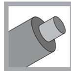
Rohrleitungen und Verbinder sind immer entsprechend der EnEV zu dämmen.
