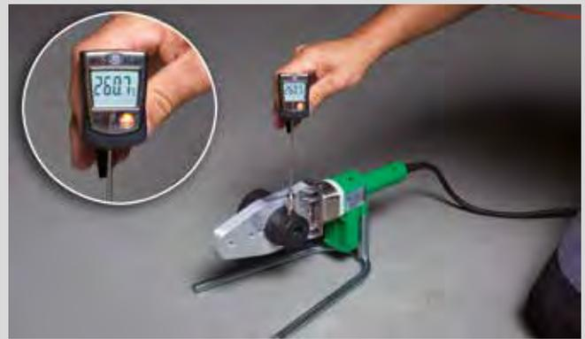
Temperaturmessung am aquatherm Handschweißgerät (800 W)
