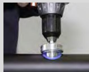
Entfernen der Sauerstoffspererschicht beim aquatherm blue pipe OT-Rohr bzw. der UV-Schicht beim aquatherm UV-Rohr
