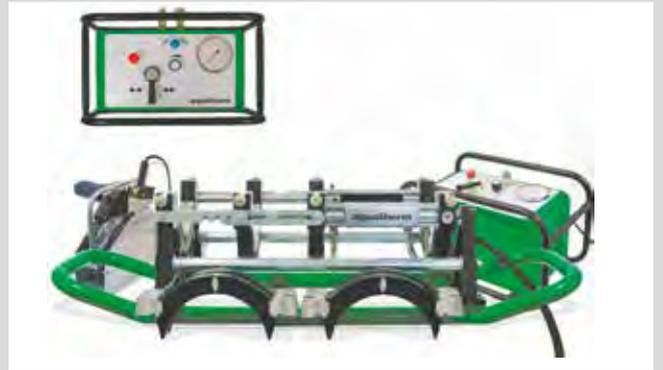
Funktionen der Schweißmaschine kontrollieren und diese aufheizen
