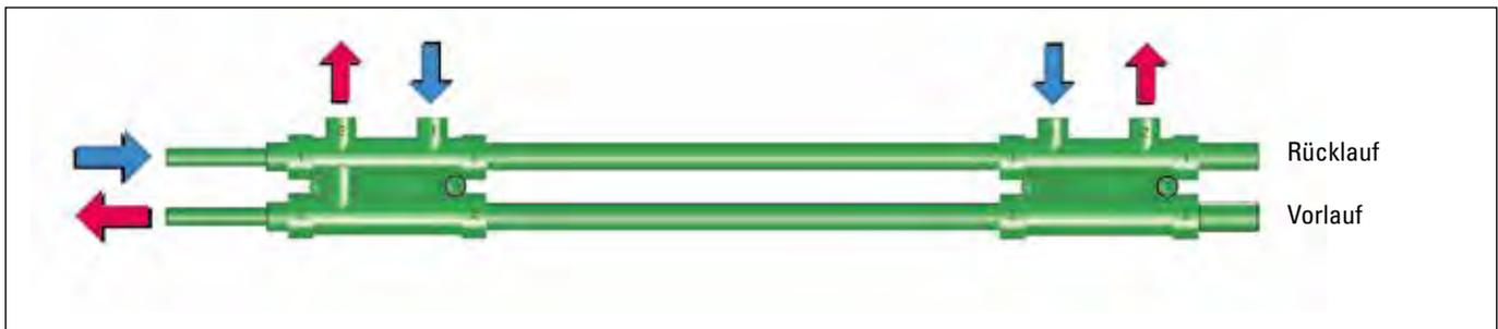
Bei der Verwendung des aquatherm Verteilerblocks spielt es keine Rolle, auf welcher Seite der Heizkörper vor- oder rücklauf angeschlossen wird. Durch Drehen des Verteilerblocks wird dieser der entsprechenden Vorgabe angepasst.
