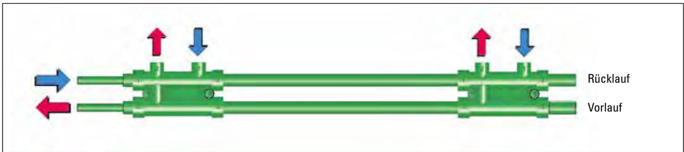
Der vor- und rücklaufseitige Anschluss der Heizungsleitungen an den aquatherm Verteilerblock wird mit aquatherm green pipe oder aquatherm blue pipe Rohren Außendurchmesser 20 mm vorgenommen. Die abgehenden 16 mm Rohrstützen ermöglichen in Verbindung mit dem aquatherm Anschlussbogen (Art.-Nr. 85120) und dem aquatherm Hahnblock (Art.-Nr. 79606 bzw. 79608) den idealen Heizkörperanschluss.
