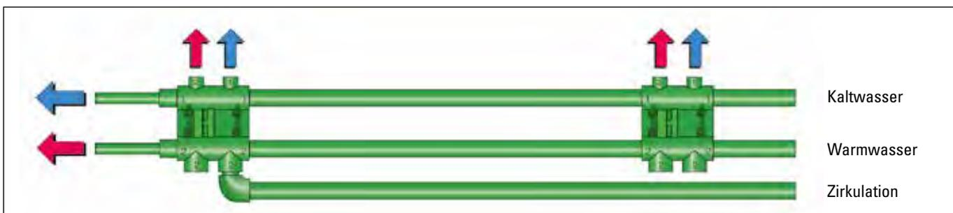
Reduzierungen für weiterführende Leitungen können unmittelbar am Verteilerblock eingeschweißt werden.
