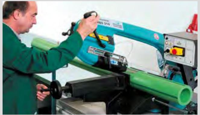
Vor dem Schweißvorgang erfolgt das Ablängen des Rohres auf die gewünschte Rohrlänge
