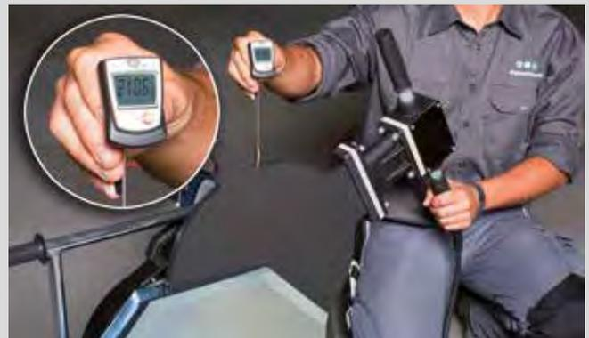
Temperaturmessung an der aquatherm Stumpfschweißmaschine
