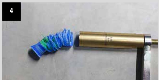
Entfernen der Bohrrückstände aus dem Bohrwerkzeug
