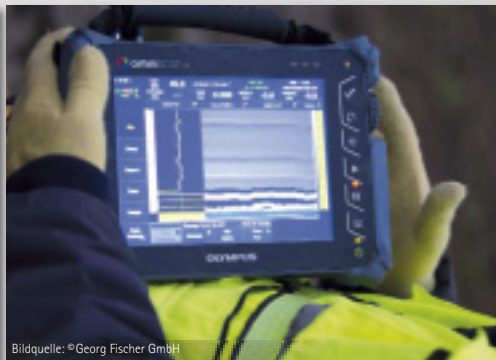
Ultraschallbild einer Stumpfschweißverbindung
