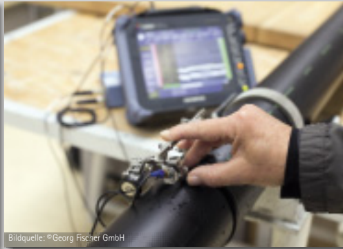
Zerstörungsfreies Prüfen einer Stumpfschweißnaht
