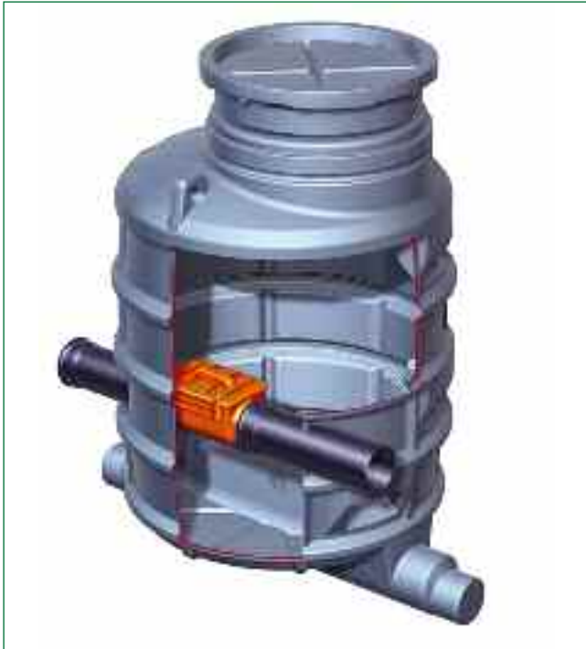
Bild 7: Dualschacht für den Einsatz im Trennsystem
