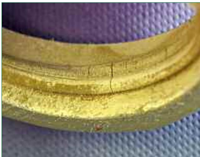
Bild 5: Versprödung von PPH-Rohren nach 3-jährigem Einsatz in 25 %  $\text{H}_2\text{SO}_4$  ( $T = 40^{\circ}\text{C}$ ) infolge nicht beachteter Chlor-Anteile im Medium; Anwendung: Herstellung von Lithographie-Druckplatten: Der Werkstoff PP ist zum Transport einer derartigen Mischung nicht geeignet.
