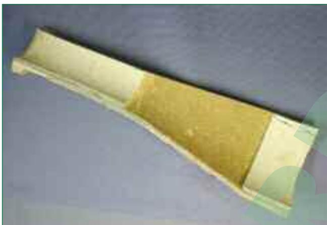
Bild 3: Grundsätzlich unterschiedlich formulierte Systemkomponenten aus PVC-C können immense Unterschiede im Korrosionsverhalten zeigen. Das Bild zeigt DEKADUR-C PVC-C Rohre zusammen mit einem Platten-Fremdfabrikat; die aus der Platte gefertigte Reduktion ist nach 4-jährigem Betrieb im Anolyt einer Chloralkali-Elektrolyse ( $T=91^{\circ}\text{C}$ ;  $\text{pH } 4\text{-}5$ ) komplett zersetzt worden.
