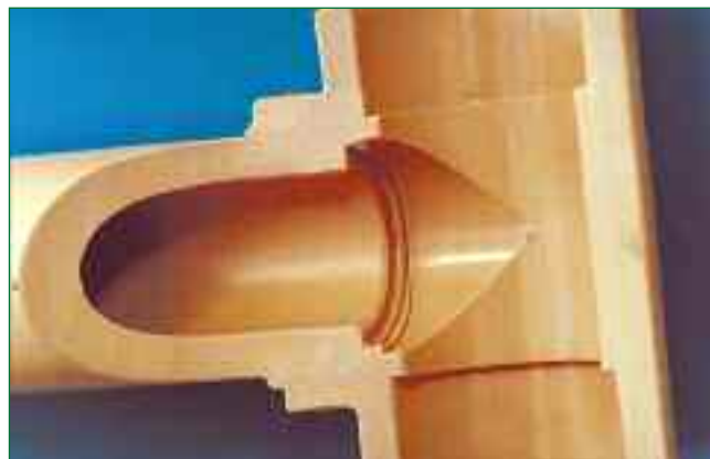
Bild 4: Rohre und Fittinge aus PP-R (Polypropylen Random-Copolymer) werden miteinander verschweißt, so entsteht eine dauerhafte, materialhomogene Verbindung
