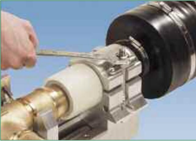
Bild 9: Die Rohrfixierung wird geschlossen
