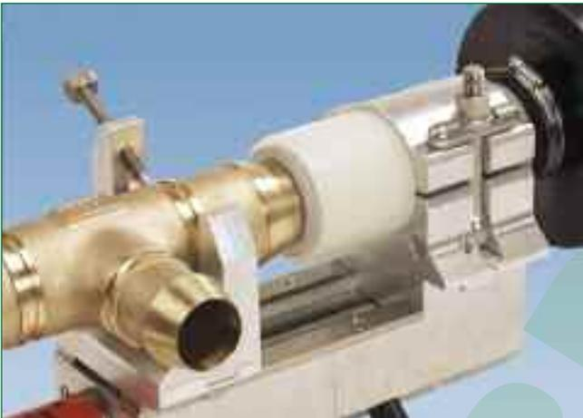
Bild 10: Der Fitting wird mit der Hydraulikpumpe bis zur Fixierung in das Rohrende eingepresst
