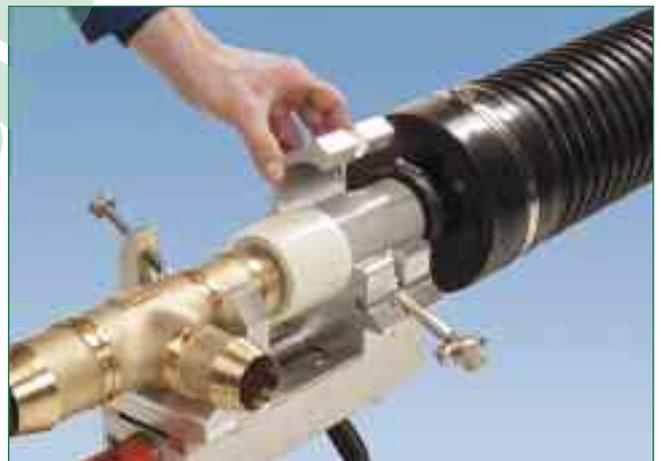
*Bild 8: Rohr und Fitting werden in das Werkzeug eingelegt*
