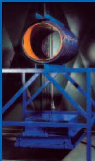
Für das Jumbo-Kanalrohr hat Pipelife nach der Prüfmethode DIN 16961 einen 70.000 Stunden Langzeittest durchgeführt, der eine Extrapolation der Belastbarkeit auf über 200 Jahre ermöglicht. Andere Rohrsysteme die mit einer Belastbarkeit von SN 16 nach DIN ISO 9969 angeboten werden, erreichen meist nicht die Langzeit-Ringsteifigkeit von Jumbo KG.
