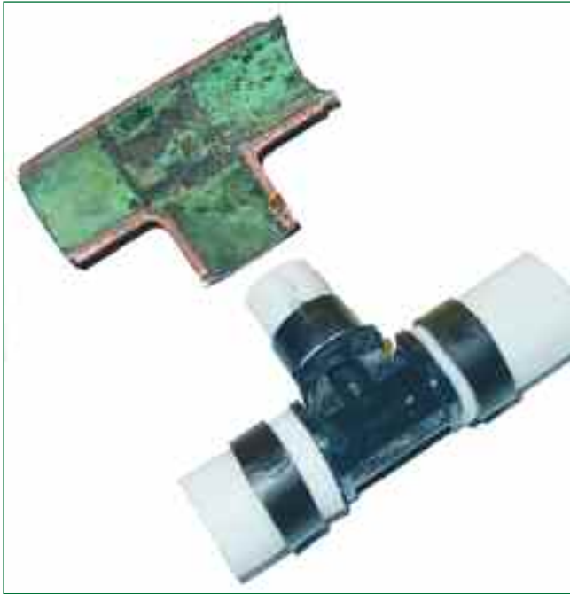
Bild 4: Korrodierter Kupferfitting (oben) und PPSU-Fitting (unten) nach 6-jährigem Einsatz in USA
