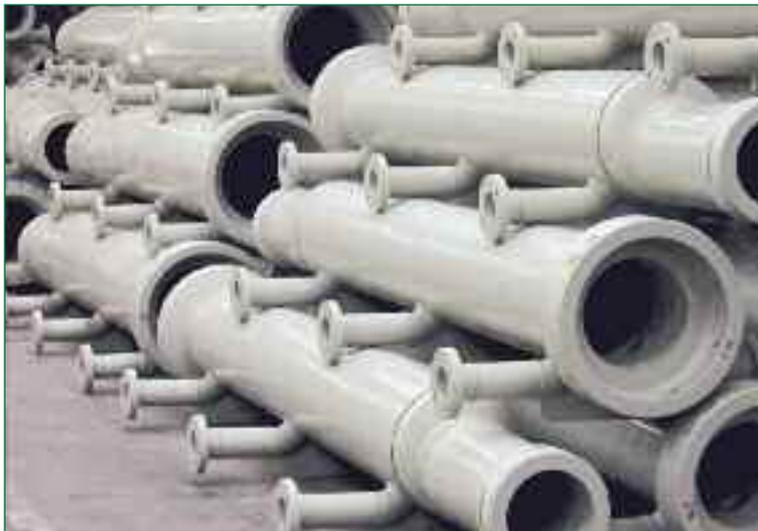
*Bild 3: Düsenlanzenteile aus PP-H 100 mit Reduzierungen und Düsenanschlussrohren, die unterhalb der Lanze angeordnet sind, damit eine vollständige Entleerung beim Stillstand erfolgt*
