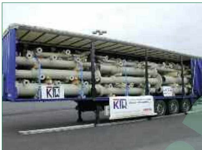
*Bild 6: Düsenlanzen auf dem LKW-Anhänger; besondere Maßnahmen gegen schlagartige Beanspruchungen mussten wegen der moderaten Außentemperatur (größer als 10°C) nicht ergriffen werden*
