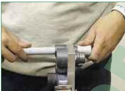
Bild 3: Das Heizelement-Muffenschweißen – ein einfacher und schneller Vorgang
