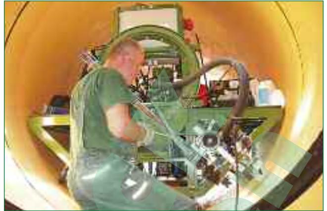
Bild 5: Extrusionsschweißung mit Roboter
