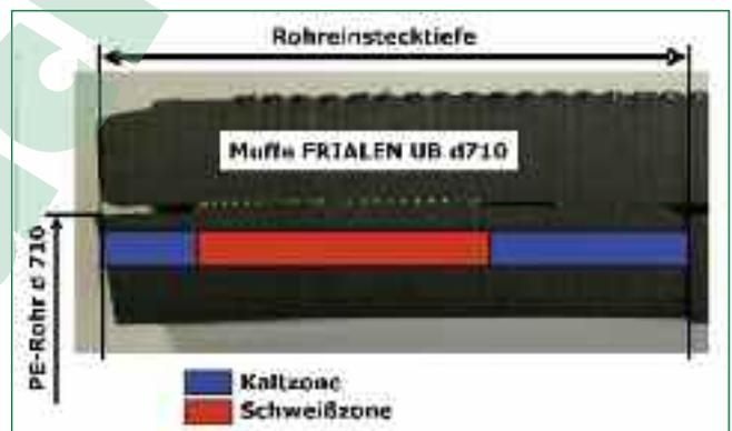
Bild 1: Schnitt durch eine Schweißverbindung d710
