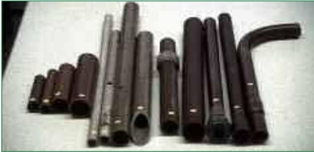
Bild 6: 1993: Untersuchte Igelit- und Vinidur-Rohre aus PVC-U von 1935-1940 [19]
