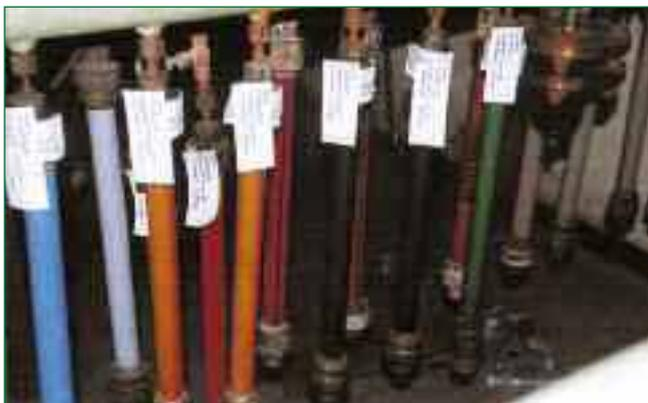
*Bild 7: PVC-U-Rohre aus dem ersten FNK-Gemeinschaftsversuch an Kunststoffrohren nach nahezu 50 Jahren Zeitstandinnendruckprüfung (20°C, 35 bar, 20 N/mm<sup>2</sup>) im Oktober 2006, Foto: Egon Barth*
