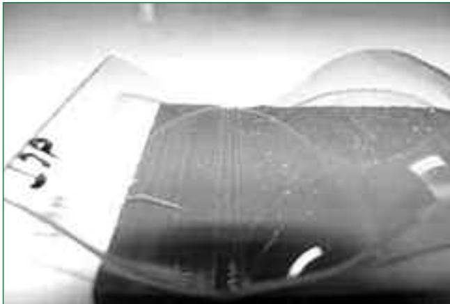
Bild 8: Verschweißung graue flache Platte / transparentes korrigiertes Profil
