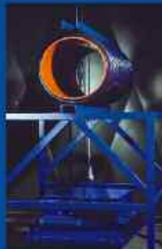
Für das Jumbo-Kanalrohr hat Pipelife nach der Prüfmethode DIN 16961 einen 70.000 Stunden Langzeittest durchgeführt, der eine Extrapolation der Belastbarkeit auf über 200 Jahre ermöglicht. Andere Rohrsysteme die mit einer Belastbarkeit von SN 16 nach DIN ISO 9989 angeboten werden, erreichen meist nicht die Langzeit-Ringsteifigkeit von Jumbo KG.
