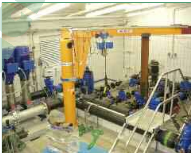
Bild 9: 2500 mal auf und zu: Armaturenprüfstand für dynamische Prüfungen an Armaturen bei 16 bar Betriebsdruck und bis zu 250 m 3 /h Durchfluss
