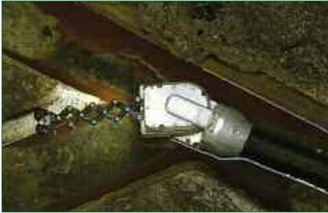
Bild 2: Für die Bedingungen der Grundstücksentwässerung (Bögen, Abzweige, kleine Nennweiten) wurden kleine, abbiegefähige Kamerasysteme wie z.B. die „Lindauer Schere“ entwickelt
