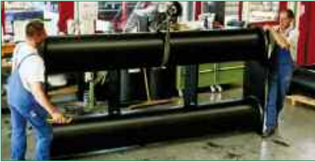
Bild 7: Herstellung der Schwimmkörper aus PE-HD Platten und Rohren
