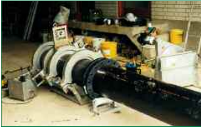
Bild 11: Stoffschlüssige Heizelementstumpfschweißung der PE-HD-Vorschweißbunde garantieren dauerhafte Dichtigkeit
