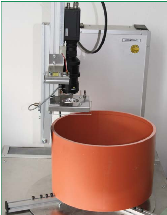
Bild 3: Prüfung der gleichmäßigen Schaumstruktur sowie der Maße des Wandaufbaus durch ein Bildanalyse-System
