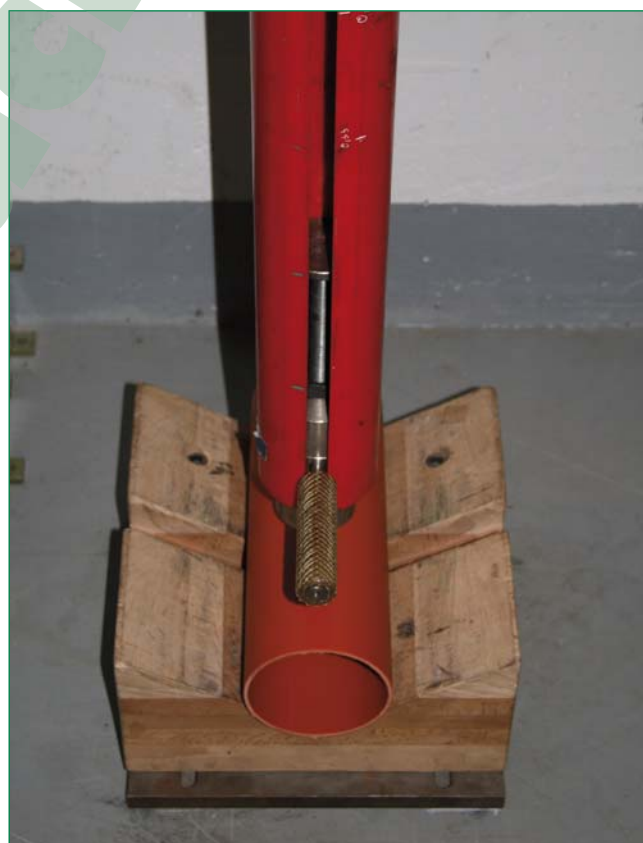
Bild 2: Nachweis der hohen Bruchfestigkeit: Kugelfalltest nach DIN EN 744
