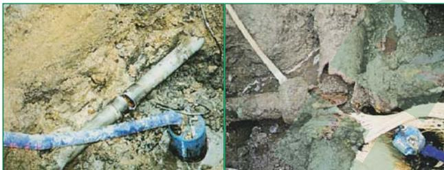
Bild 1, links: gebrochene PVC Verbindung und Bild 2, rechts: gebrochenes gusseisernes Kreuzstück (DN 250 x 150) nach dem Erdbeben in Kobe/Japan
