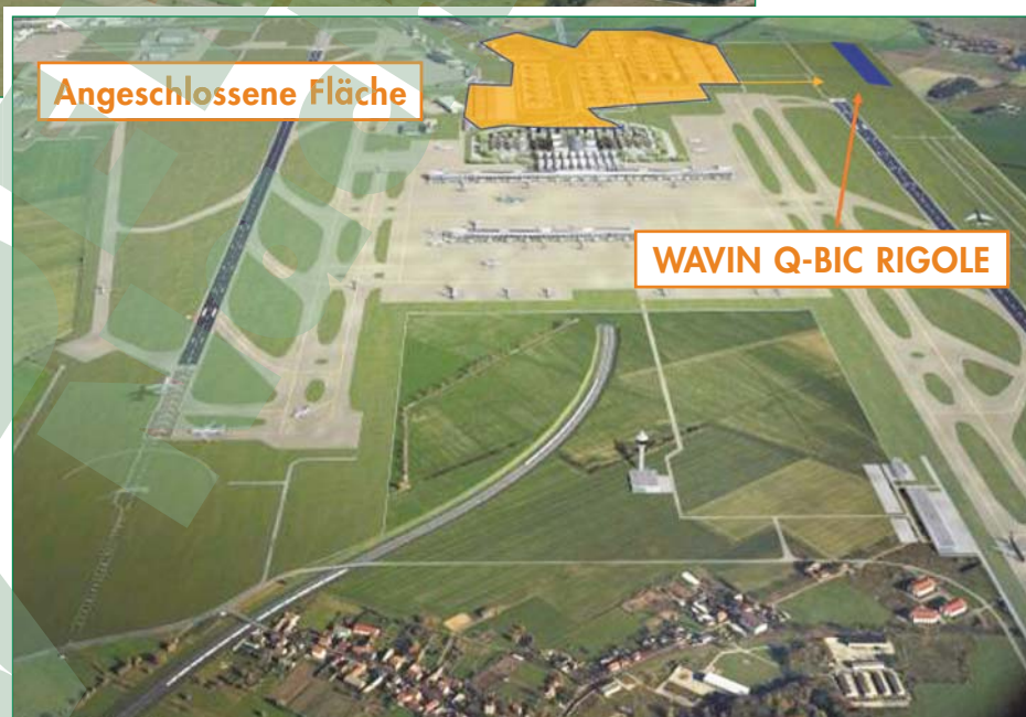
Bild 1b (rechts): Ebenfalls eine Simulation des Flugplatzes. Markiert wurde der Einzugsbereich, aus dem das zu versickernde Regenwasser stammt. Da es sich um Verkehrsflächen handelt, ist eine naturnahe Vorbehandlung (Bodenfilter) vor der Versickerung über ein Mulden-Rigolen-System vorgesehen (rechts oben eingezeichnet); Foto: ©Dirk Laubner, Visualisierung: buenck+fehse gmbh / Berliner Flughäfen, Digitale Medien GmbH, bearbeitet von Wavin GmbH
