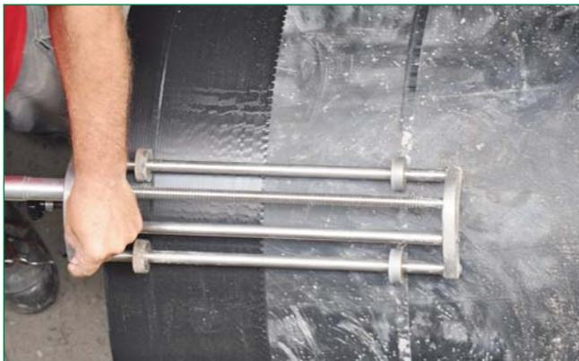
Bild 5: Zuverlässige Entfernung der Oxidhaut gemäß DVS 2207 mit dem Schälgerät FWSG 710 L
