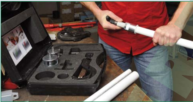
Bild 2: Stephan Blißenbach, H.J. Lohmar GmbH, schätzt das werkzeugarme und zeitsparende Verlegen von Rohrleitungen; hier Anfasen eines TECElogo-Rohres
