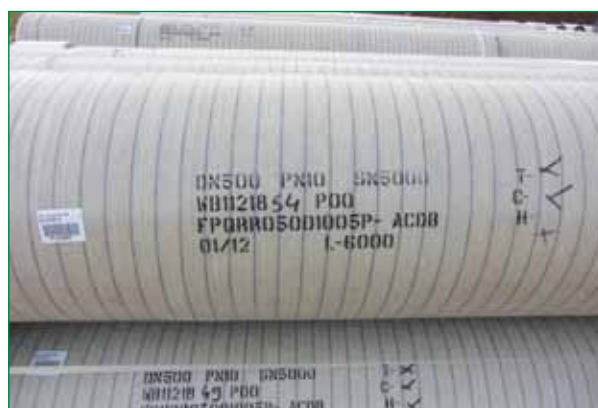
Bild 4: FLOWTITE GFK-Rohre: Bei Auftragsvergabe brachten vor allen Dingen die Werkstoffeigenschaften den Zuschlag
