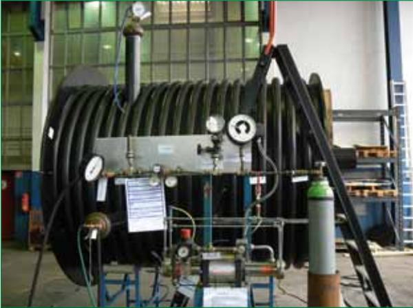
*Bild 3: Prüfeinrichtung für die Druckprüfung > 20 bar*
