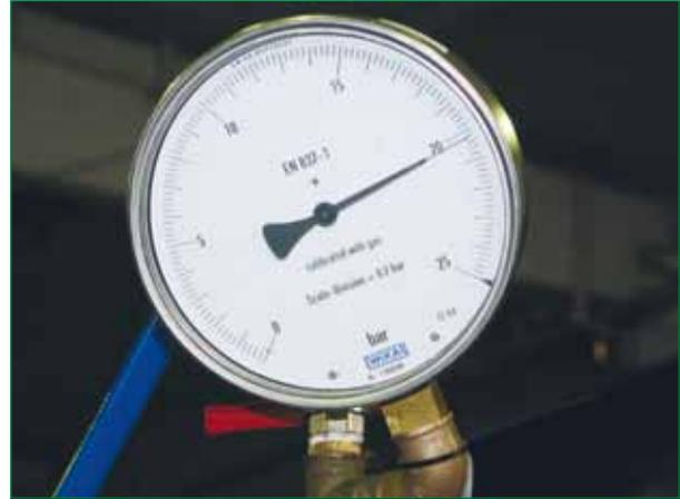
*Bild 4: Manometer mit Prüfdruck > 20 bar*
