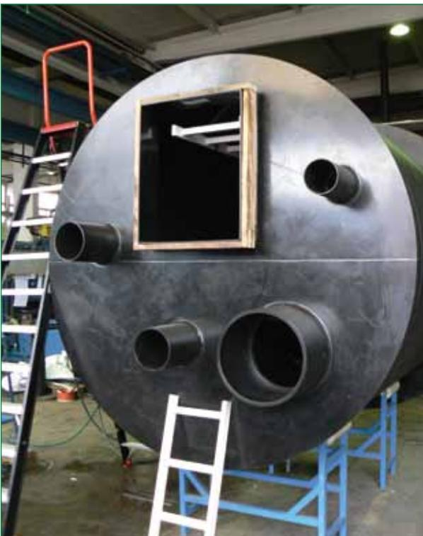
Bild 7: Unterdruckprüfung an Tegra 1000-Schacht
