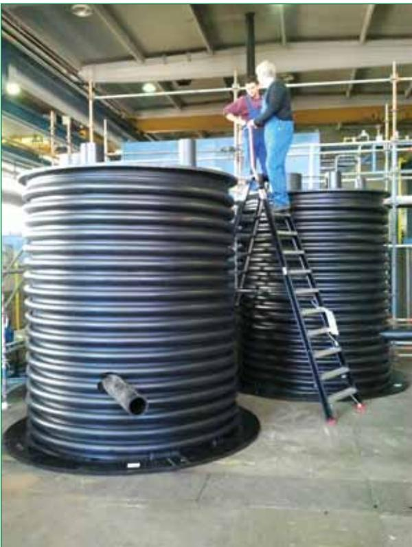
*Bild 5: Dichtheitsprüfung mit Wasser*
