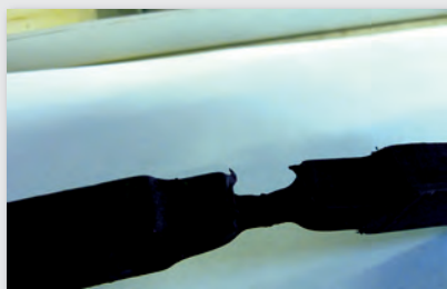
Probekörper nach Zeitstandbruch in der Schweißebene.
