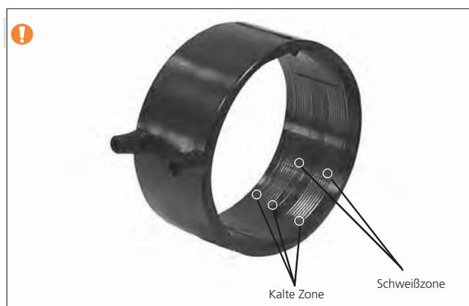
Abbildung 3.111 Akafusion Elektroschweißmuffe mit kalter Zone und Schweißzone
