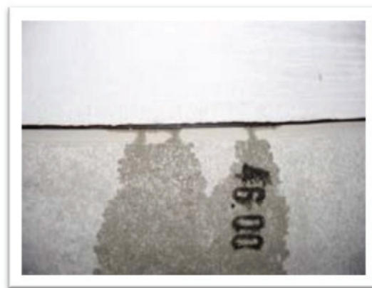
Abbildung 9-D: Austrittendes Wasser bei der Prüfung
