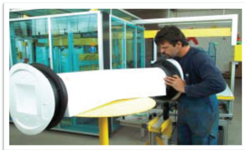
Abbildung 7-F: Negativform mit Dichtringen
