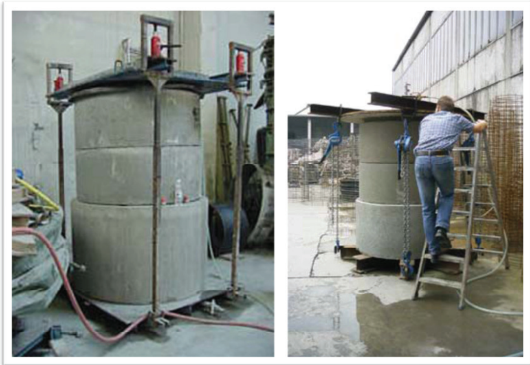
Abbildung 9-G: Prüfung der Betonschächte beim Hersteller
