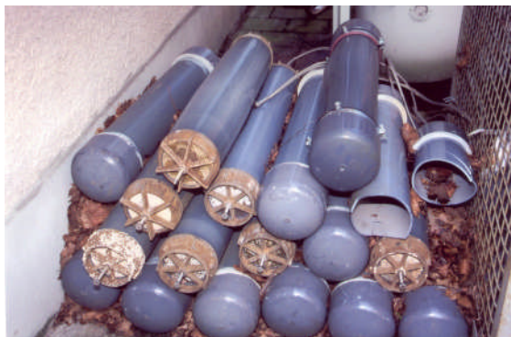
Bild 34: Rohrabschnitte 160 x 4,7 mm mit unterschiedlichen Prüfverschlüssen nach Abschluss der Zeitstand-Innendruckversuche
