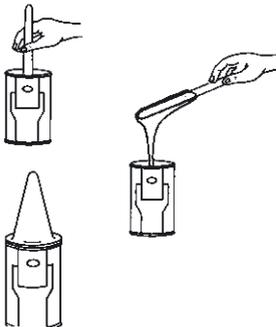
Dose sowohl in Arbeitspausen als auch nach Gebrauch verschließen. Zum Verschließen der Dose während der laufenden Arbeiten ist eine Pinseltülle gut geeignet. Der Pinsel kann dabei in der Klebstoffdose bleiben.
