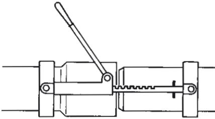
Bei Rohrdimensionen ab etwa 160 mm wird das Fügen durch die Verwendung einer geeigneten Zusammenziehvorrichtung erleichtert. Empfehlungen hierzu geben die Rohrhersteller.
