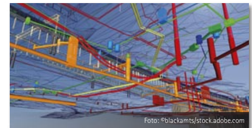
Bild 43: Digitales Bauwerksmodell der unterirdischen Infrastruktur
