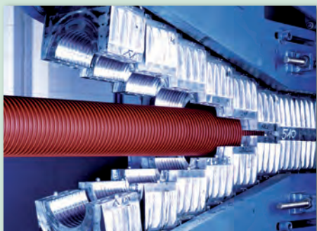
Extrusionsverfahren für profilierte Rohre
