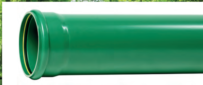
Bild 6: Das Abwasserrohr-System „GreenTube SN 10“ von Alphacan Omniplast: gut zu erkennen die bewährte, aber hochwertig optimierte, doppelwandig-bionische Sandwichkonstruktion mit dem homogen gefüllten, geschlossenporigen Zellkern. Innen die gelb-schwarze HB-FIX Lippendichtung – ein „Nahezufest“-Dichtring, der absolut treibstoff- und mineralölbeständig sowie dicht und wurzelfest ist.
