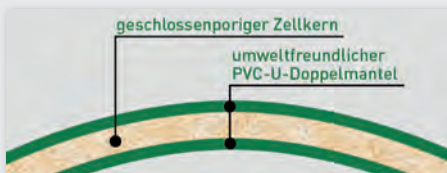
Bild 4: Schemazeichnung von Omniplast GreenTube Der bionische Aufbau des GreenTube-Rohres nach dem Vorbild eines natürlichen Grashalmes trägt zu einem besseren Ausgleich von Drücken und Punktbelastungen durch eine elastischere Druck-Zug-Neutralisierung bei geringerem Gewicht bei.
