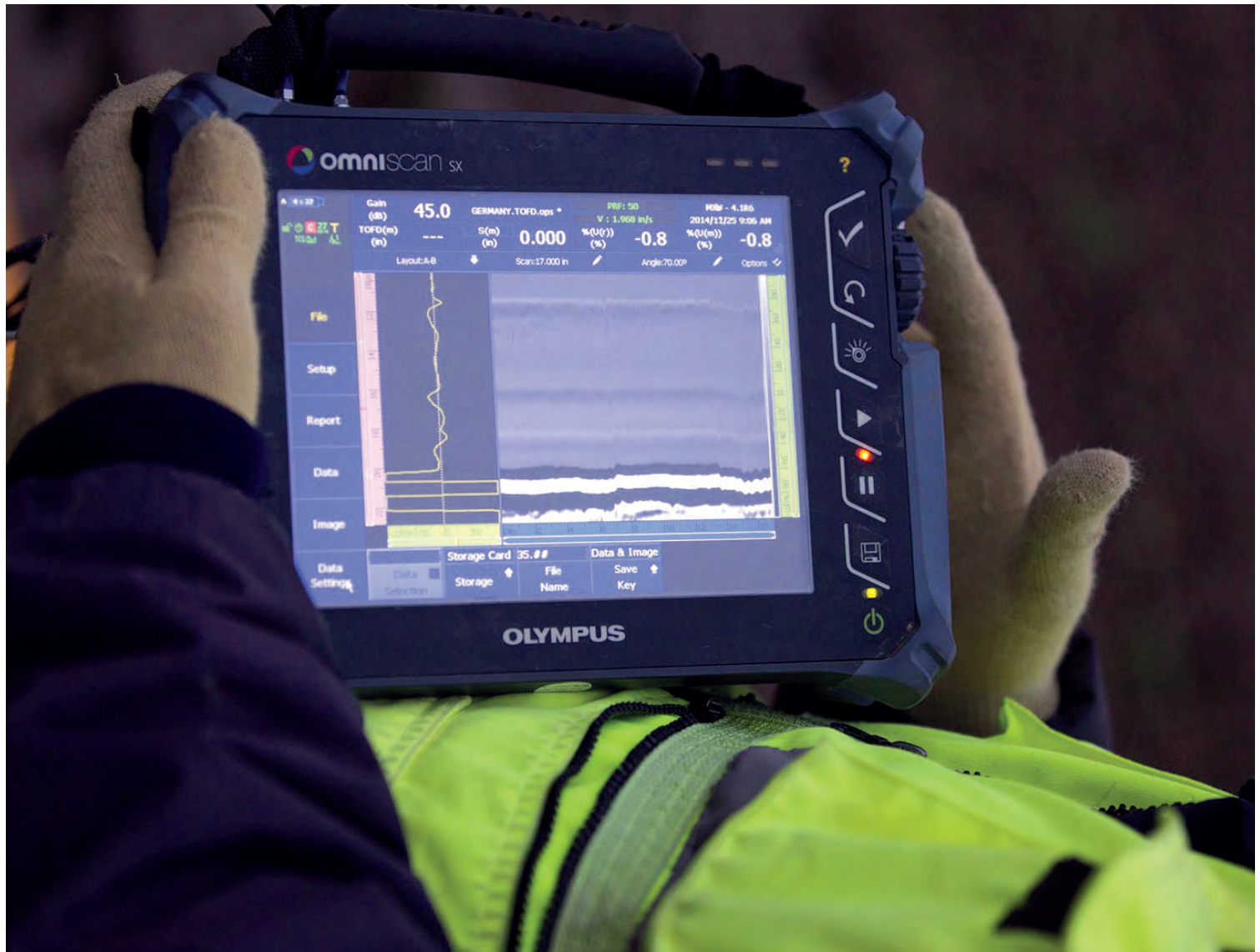
Bild 2: Ultraschallbild einer Stumpfschweißverbindung
