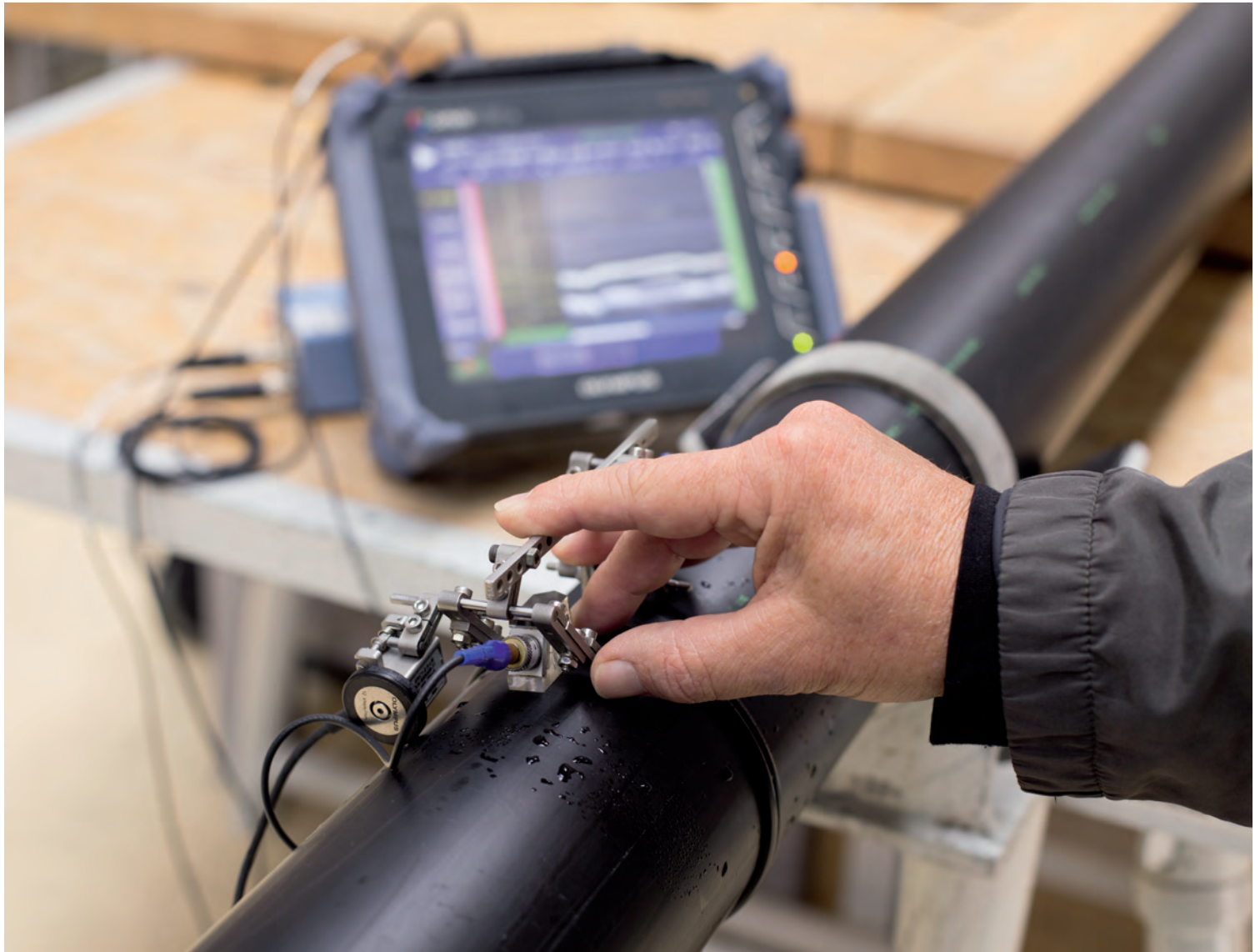
Bild 1: Scannen einer Stumpfschweißnaht
