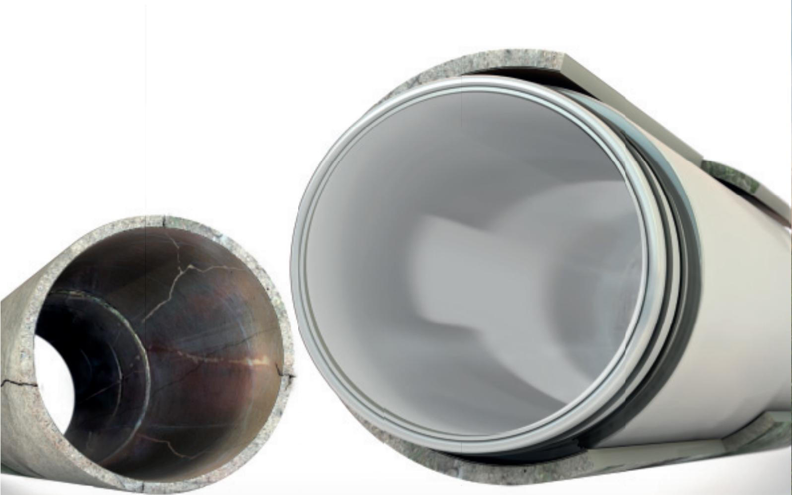
Das neue SIMONA® PP-HM Rohrsystem für die nachhaltige Sanierung von Entwässerungssystemen: spannungsarm getempert und zu 100% füllstofffrei. Für alle Projekte in geschlossener Bauweise über Schächte und Kleinbaugruben. SIMONA® PP-HM Produkte erfüllen die Anforderungen an Hochlastrohre mit einem Elastizitätsmodul  $> 1.700$  MPa, der DIN EN 1852-1 folgend. Weitere Informationen zur Sanierung mittels Rohrlining mit Ringraum, Tight in Pipe (TIP) und Berstlining finden Sie unter:
