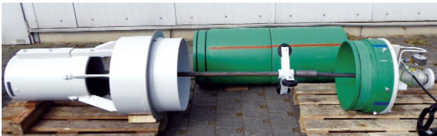
Bild 5: Maschinentechnik zum Einzug mit zusätzlicher Aufweitung Fa. Bohrtec
