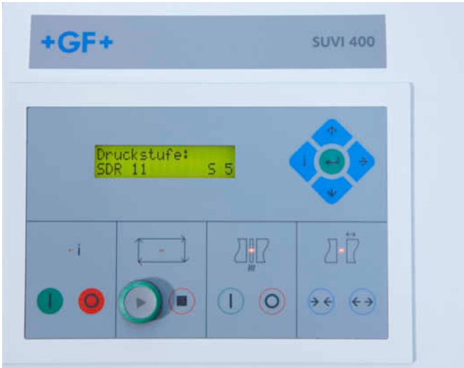
Auf dem Display blinkt: Druckstufe: SDR 11, S 5. Die Druckstufe gibt an, für welchen Druck das Rohr ausgelegt ist. INSTAFLEX Big = PN10
