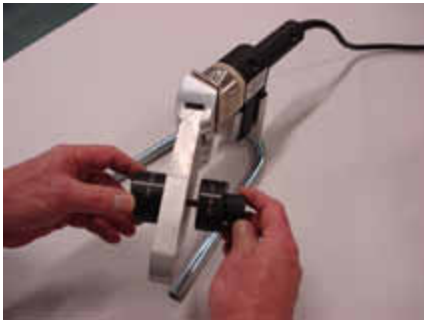
Montieren Sie die Heizbuchsen auf den Schweiss-Spiegel.
