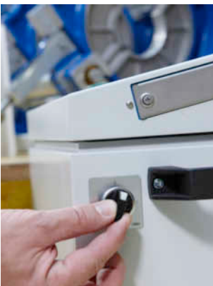
Schalten Sie die Steuereinheit Suvi 400 mit dem Gerätehauptschalter an der rechten Geräteseite ein.
