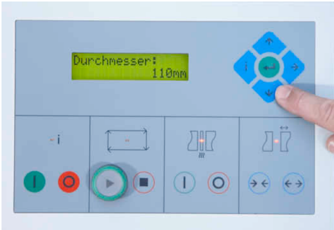
Wählen Sie die Rohrdimension mit den blauen Pfeiltasten.
