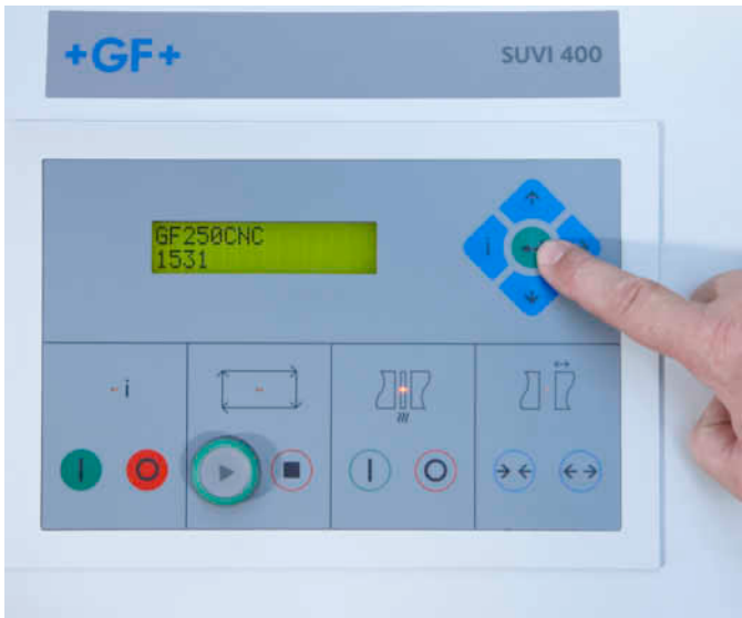
Prüfen Sie die Einstellungen. Wenn die Einstellungen richtig sind, bestätigen Sie mit der grünen Taste Enter.
