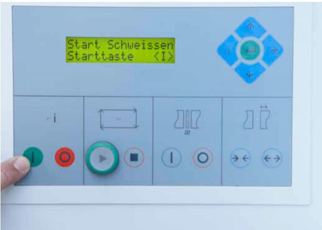
Auf dem Display erscheint: Start Schweißen Starttaste. Drücken Sie die grüne Taste I.
