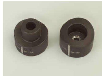
Reinigen Sie nach jeder Schweissverbindung die Heizbuchsen. Für die nächste Schweissverbindung darf kein Polybuten auf den Heizbuchsen sein.
