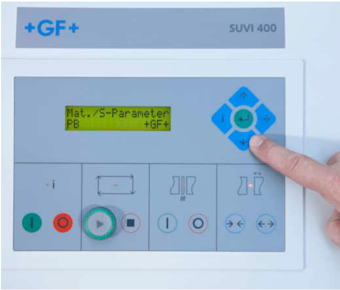
Wählen Sie das verwendete Material mit den blauen Pfeiltasten. Bei INSTAFLEX BIG wählen Sie PB.
